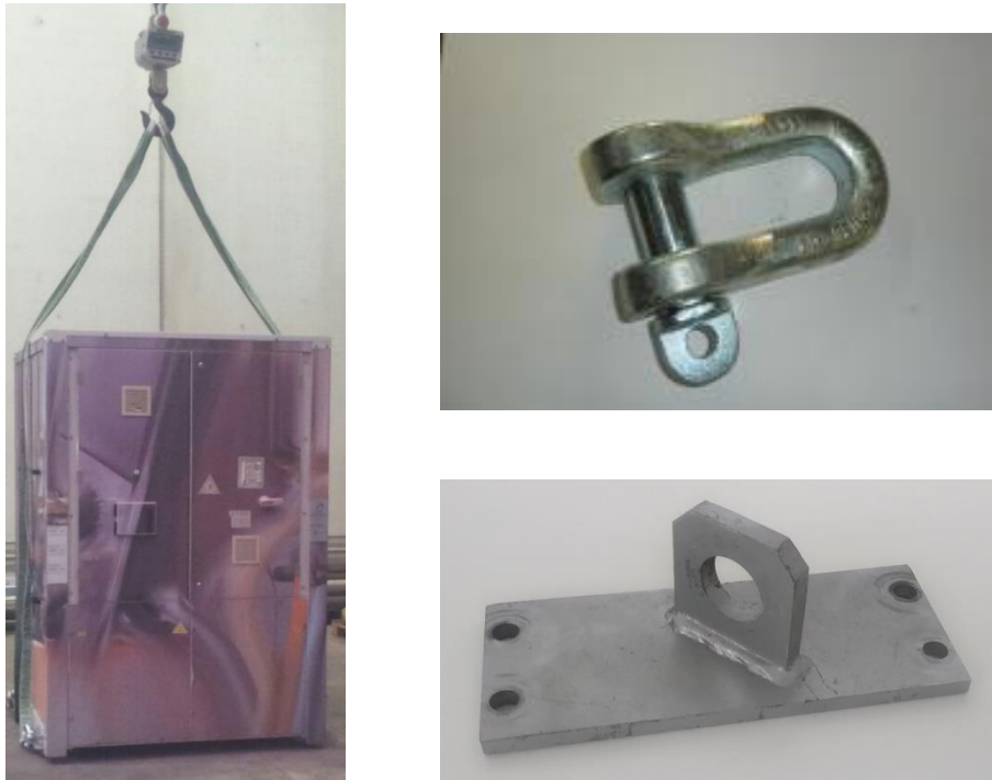
Figura 4: sollevamento e particolari staffa e grillo
